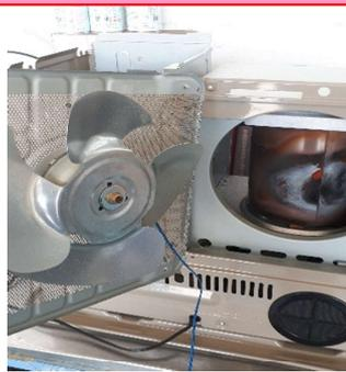
※宮作の分解掃除は、ばらせる部品はすべて分解し洗剤で水洗い！ホコリや綿ゴミをキレイに洗い流します。熱で傷んだ部品も、新しい部品（別途料金）に交換します。
